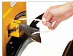
Sostituzione facile e veloce della bobina
