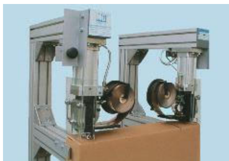
SGR 2 /LE/B 36 con 2 teste di graffatura per graffatura longitudinale.
